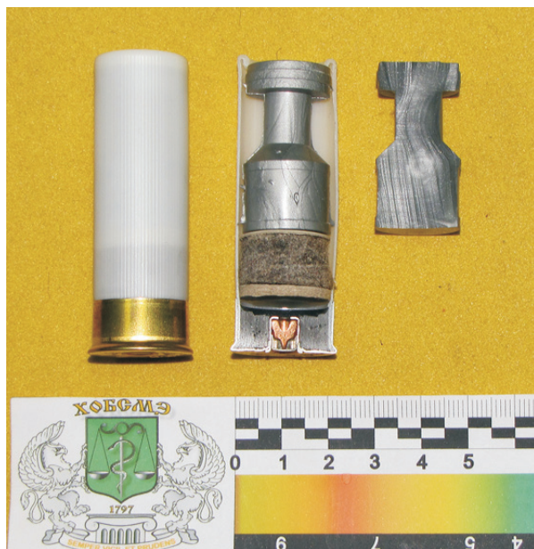
Рис. 1. Загальний вигляд патрону 12-го калібру «Терен-12П» та кулі, якою він споряджений
